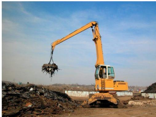
Máquina com eletroímã para recolhimento de detritos metálicos em depósito de lixo. Foto: dvande / Shutterstock.com
